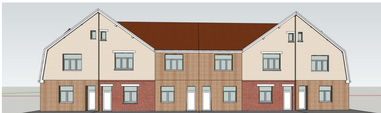
Graphique 1: Proposition 1: Isolation avec du matériel biobasé, finition avec un bardage en bois
